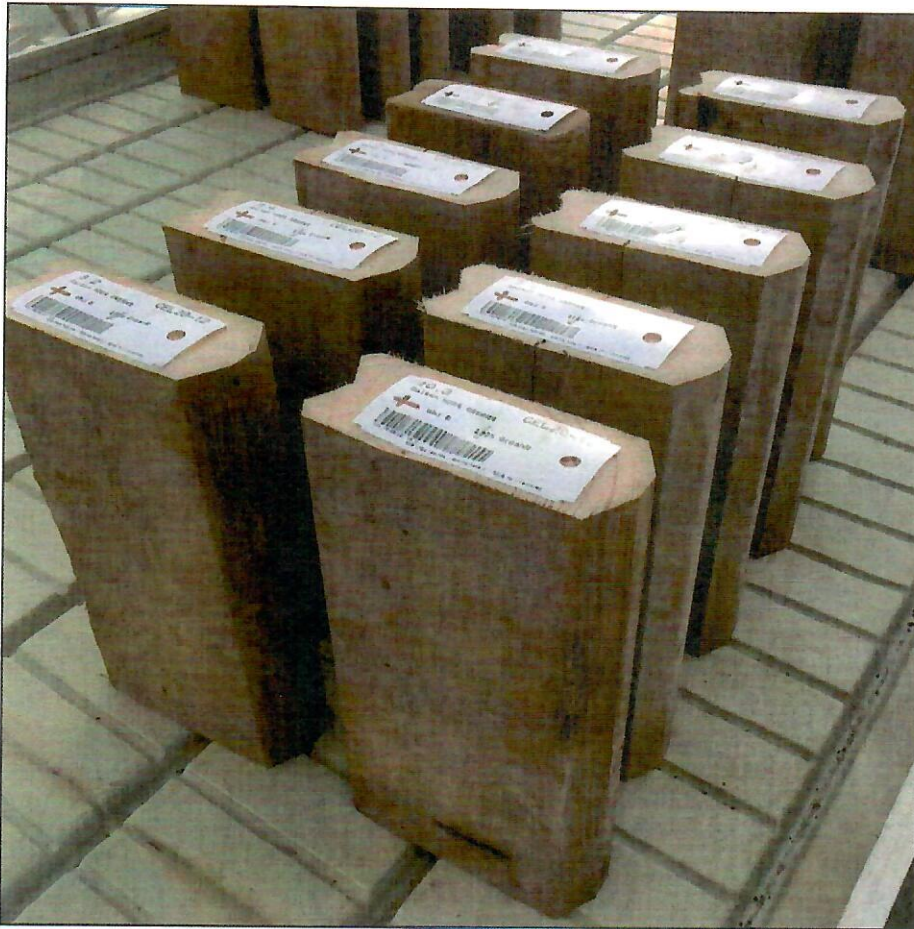
Tijdens de beproeving hebben WUR-onderzoekers de ongeschaafde balken onder een schijfvervelaar door laten lopen om het middel goed te verdelen in de juiste concentratie.
